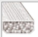
**Aluminiumabstandhalter** sind temperatur-, UV- und alterungsbeständig, nehmen dynamische Belastungen auf und besitzen mit einem längenbezogenen Wärmedurchgangskoeffizienten von 0,064 W/(mK) auch gute Wärmedämmeigenschaften.
