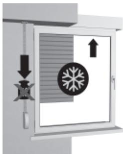
Bei Frost kann der Rollladen anfrieren. Vermeiden Sie eine gewaltsame Betätigung und verzichten Sie bei festgefrorenem Rollladen auf ein Öffnen oder Schließen.
