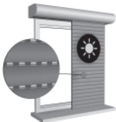
Bei Verwendung der Rollläden als Sonnenschutz empfehlen wir Ihnen, diese nicht vollständig zu schließen, sodass eine Hinterlüftung gewährleistet ist. Bei Kunststoffrollläden wird außerdem die Gefahr von Verformungen verringert.
